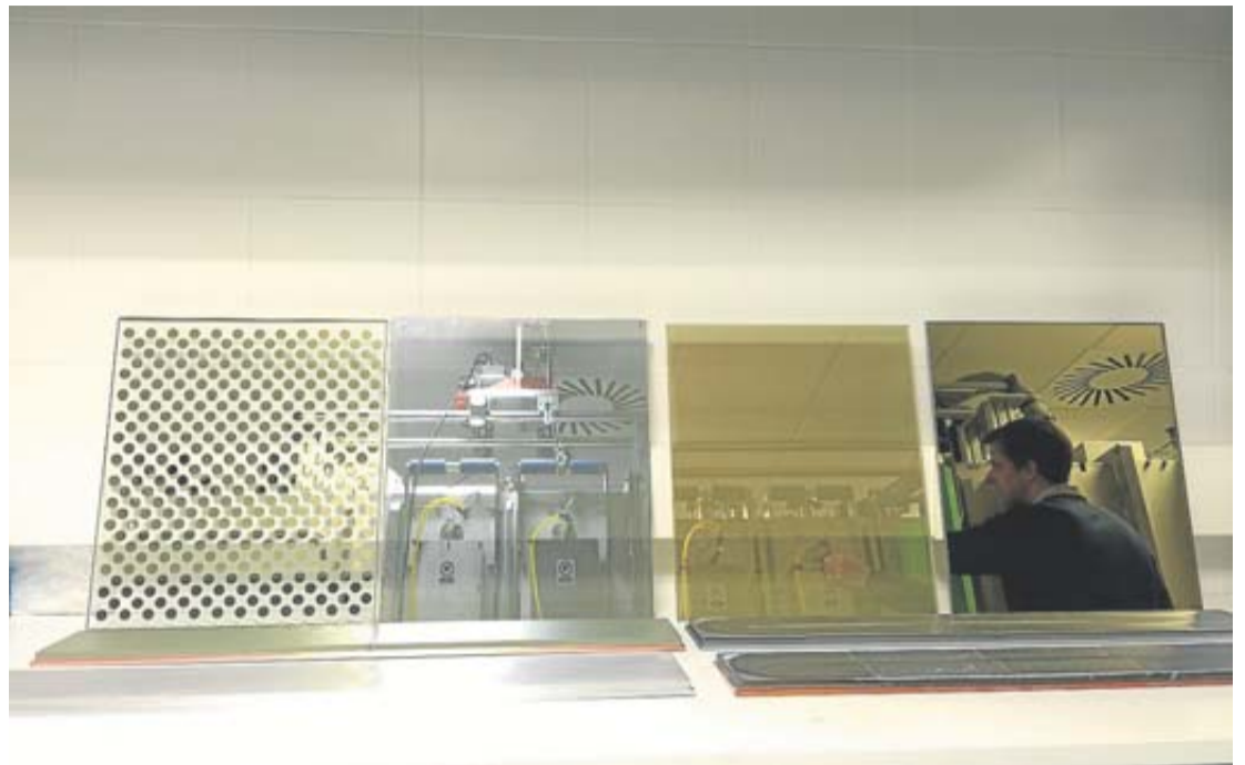
Muestras de vidrio con multicapas para propiedades estéticas actuando sobre el espectro visible. UNIZAR
